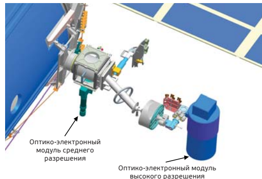
Рис. 1. Схема размещения оптико-электронных модулей на российском сегменте МКС
