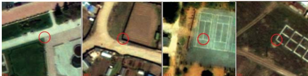
Рис. 3. Примеры выбора контуров наземных контрольных точек
