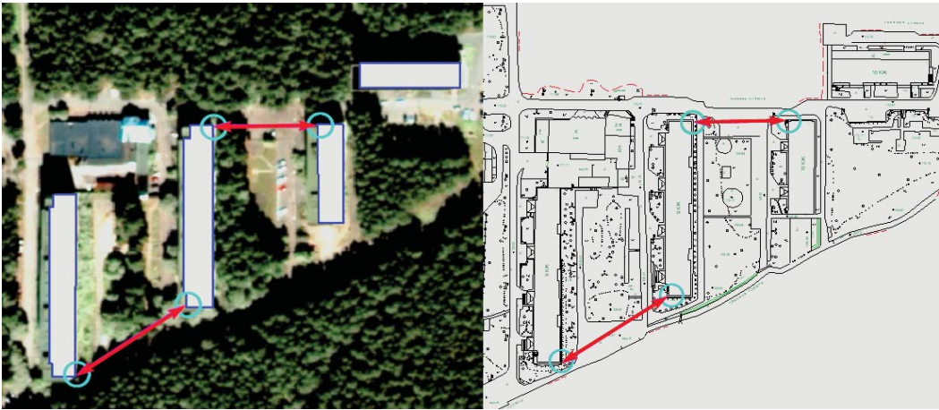
Рис. 5. Примеры выбора контуров при оценке точности взаимных расстояний
