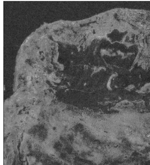
Рис. 12. Изображение когерентности фаз радарных съемок. Значения когерентности, близкие к нулю, — темный цвет, близкие к единице — белый цвет. Перепад значений от нуля к единице соответствует перепаду цветов от темного к белому через градации серого цвета
