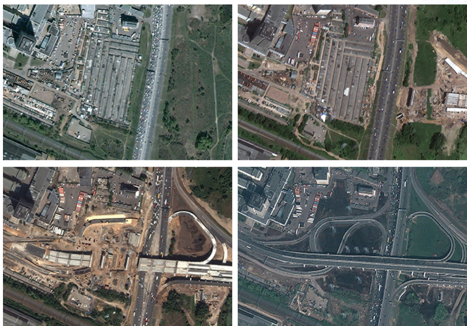
Рис. 1. Пример мониторинга строительства крупной многоуровневой транспортной развязки (Москва, МКАД развязка Косинская)
